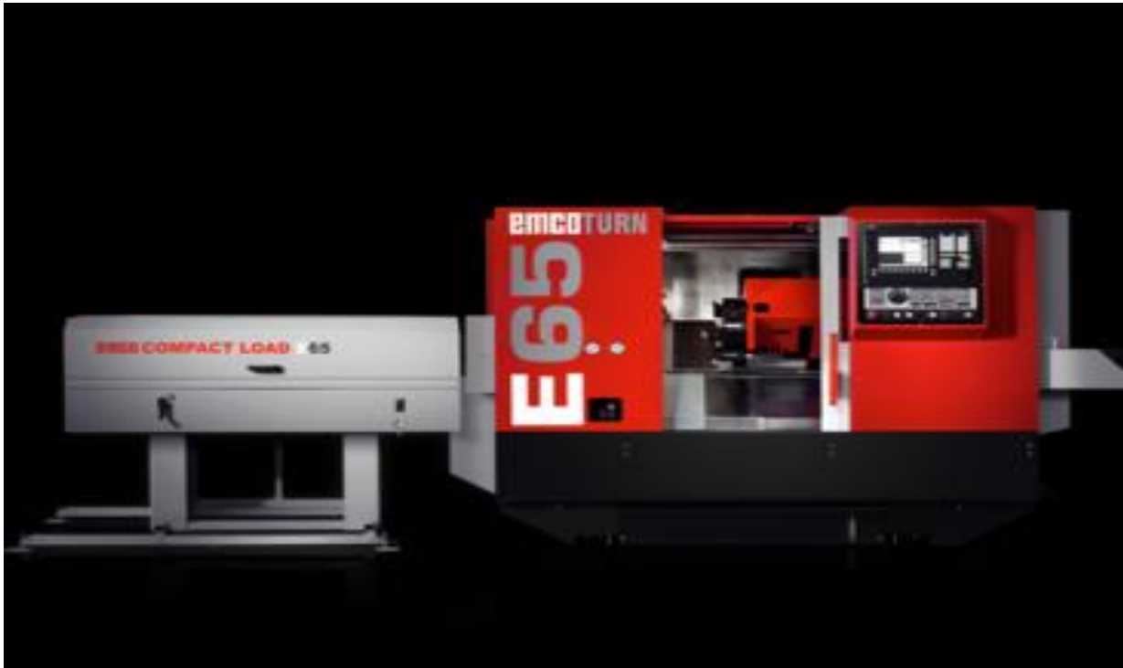
EMCO E 65 CNC Bearbeitungszentrum mit 1500 mm Stangenlader, Bj.2007
